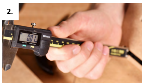
2. P-14-verbindingshelften inschuiven en de diepte meten van de verzonken verbinder
