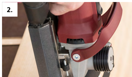
2. Frezing in de rand met het opsteekplaatje van 2 mm (freesdiepte 12 mm)
