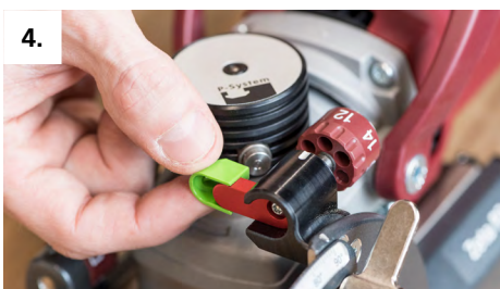
4. P-System opzetstuk voor diepteregeling van 4 mm aanbrengen (effectieve freesdiepte 8 mm)
