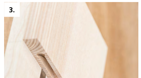
3. Lijn de plank als aanslag versprongen uit met behulp van het opsteekplaatje van 2 mm
