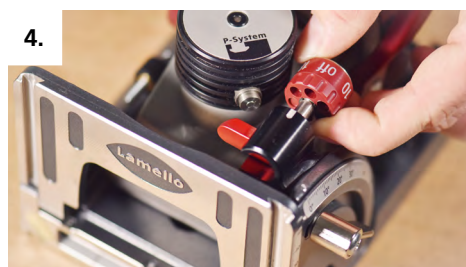
4. Pour le réglage, tirez la butée de profondeur P-System et tournez-la sur « Off »
