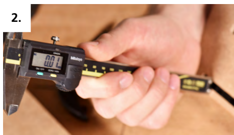
2. Insérez les demi-coques P-14 et effectuez la mesure de recul
